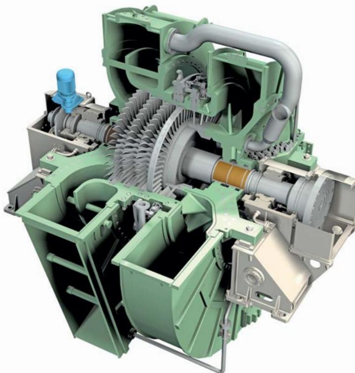
3-D модель газовой утилизационной бескомпрессорной турбины
