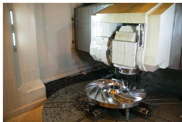
Обработка основного диска с лопатками рабочего колеса ЦБК
