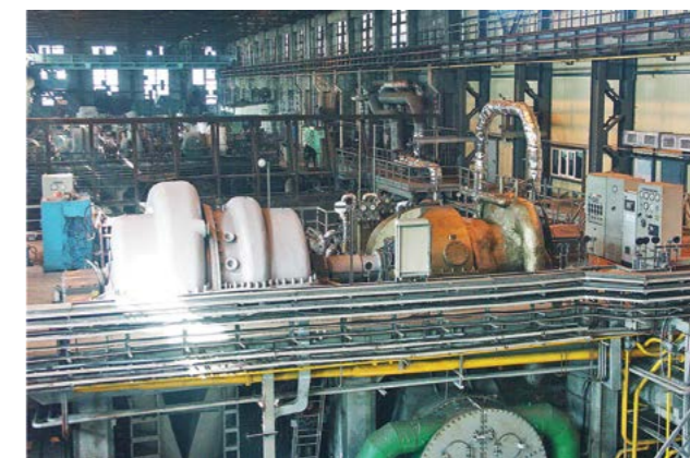
Турбокомпрессорный агрегат на металлургическом комбинате «Азовсталь»
