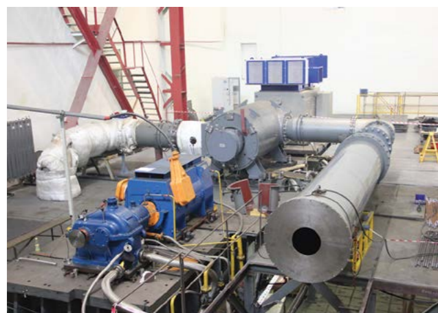
295 СПЧ 3.0 на испытательном стенде
