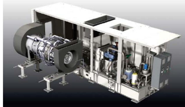
Боковая выкатка всего газотурбинного двигателя из-под кожуха
