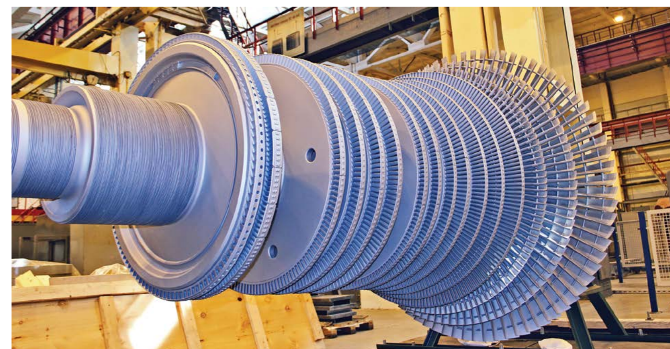
Ротор турбины К-22-90-2М
