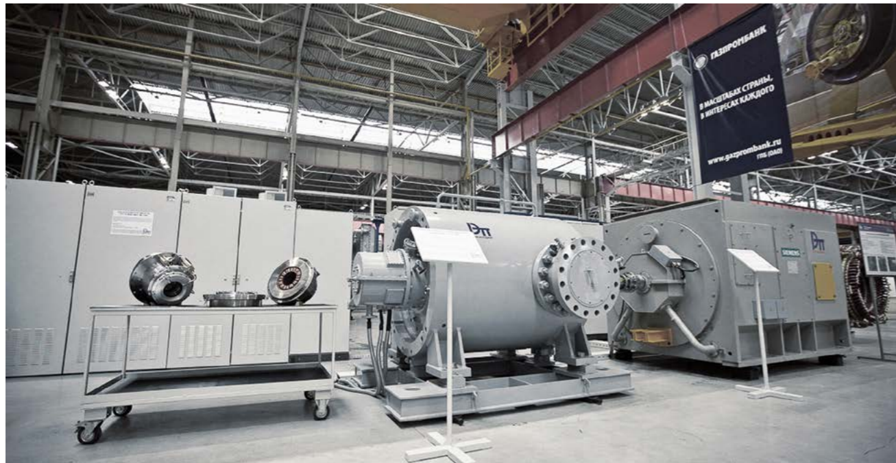
Электроприводной газоперекачивающий агрегат
