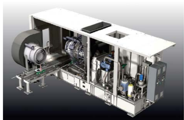
Боковая выкатка силовой турбины из-под кожуха
