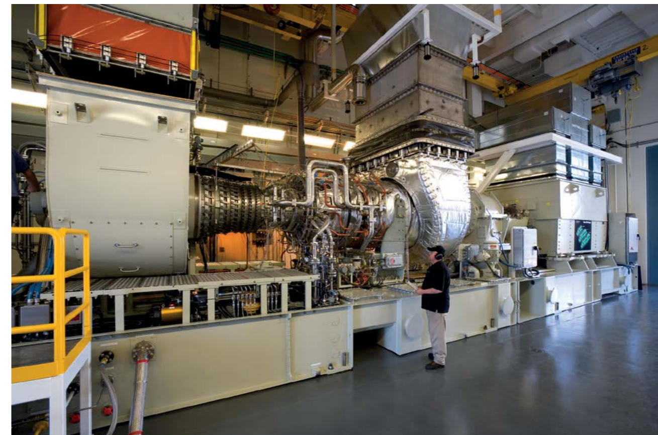
ГТУ Т25 на испытательном стенде
