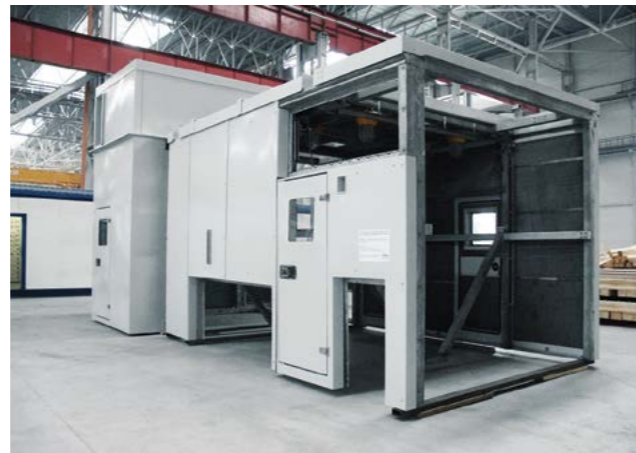
Кожух шумотеплоизолирующий ГТУ
