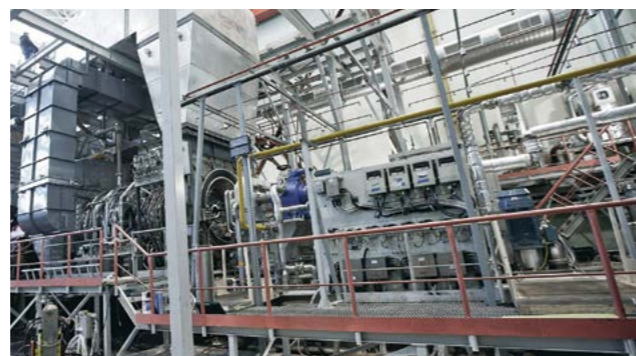
Испытательный стенд газовых турбин мощностью 32МВт
