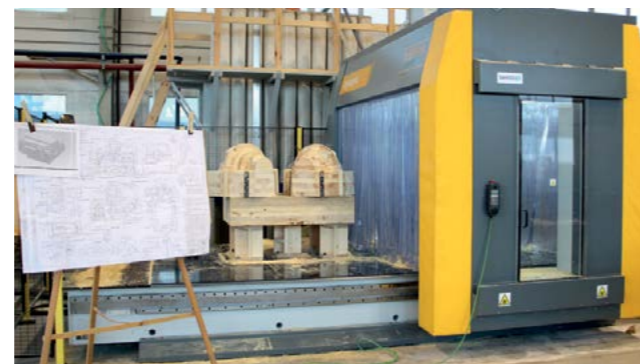
Пятикоординатный станок Dinamic FC 4000 спс для изготовления моделей
