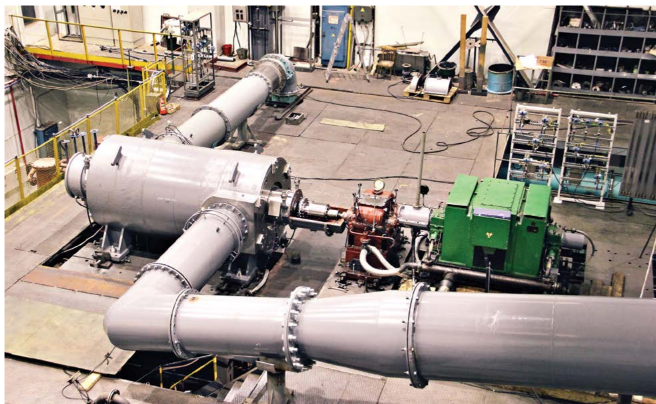
СПЧ на испытательном стенде производственной площадки «Невский Завод»
