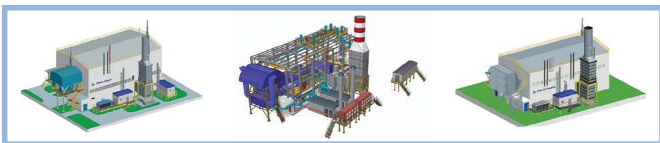
Варианты компоновок ГПА на компрессорных станциях
