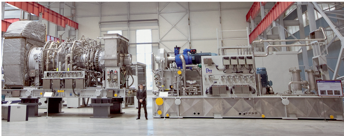
Блок ГТД с патрубками входа/выхлопа (слева) и рама вспомогательных устройств (справа) на производственной площадке «РЭП Холдинг»
