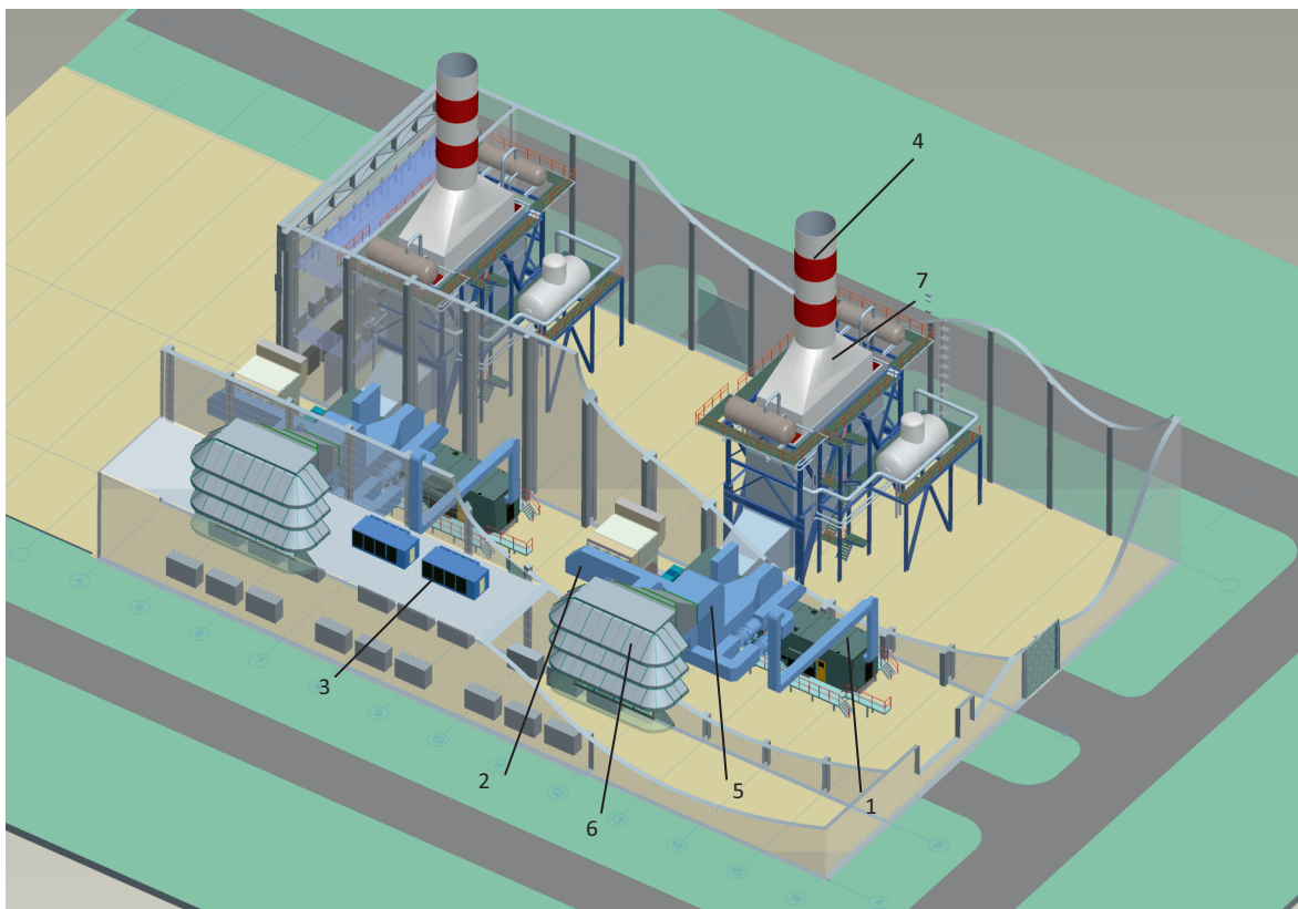
Компоновка основного оборудования ГТУ-ТЭЦ
