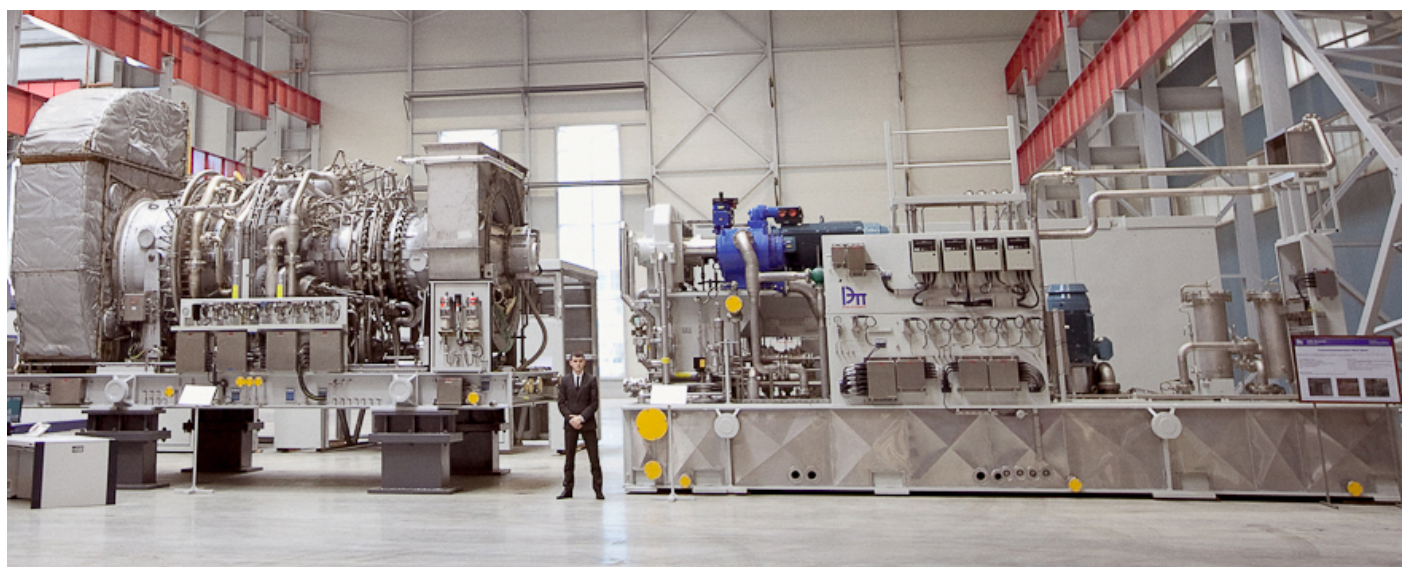
Блок ГТД с патрубками входа/выхлопа (слева) и рама вспомогательных устройств (справа) на производственной площадке «РЭП Холдинга»
