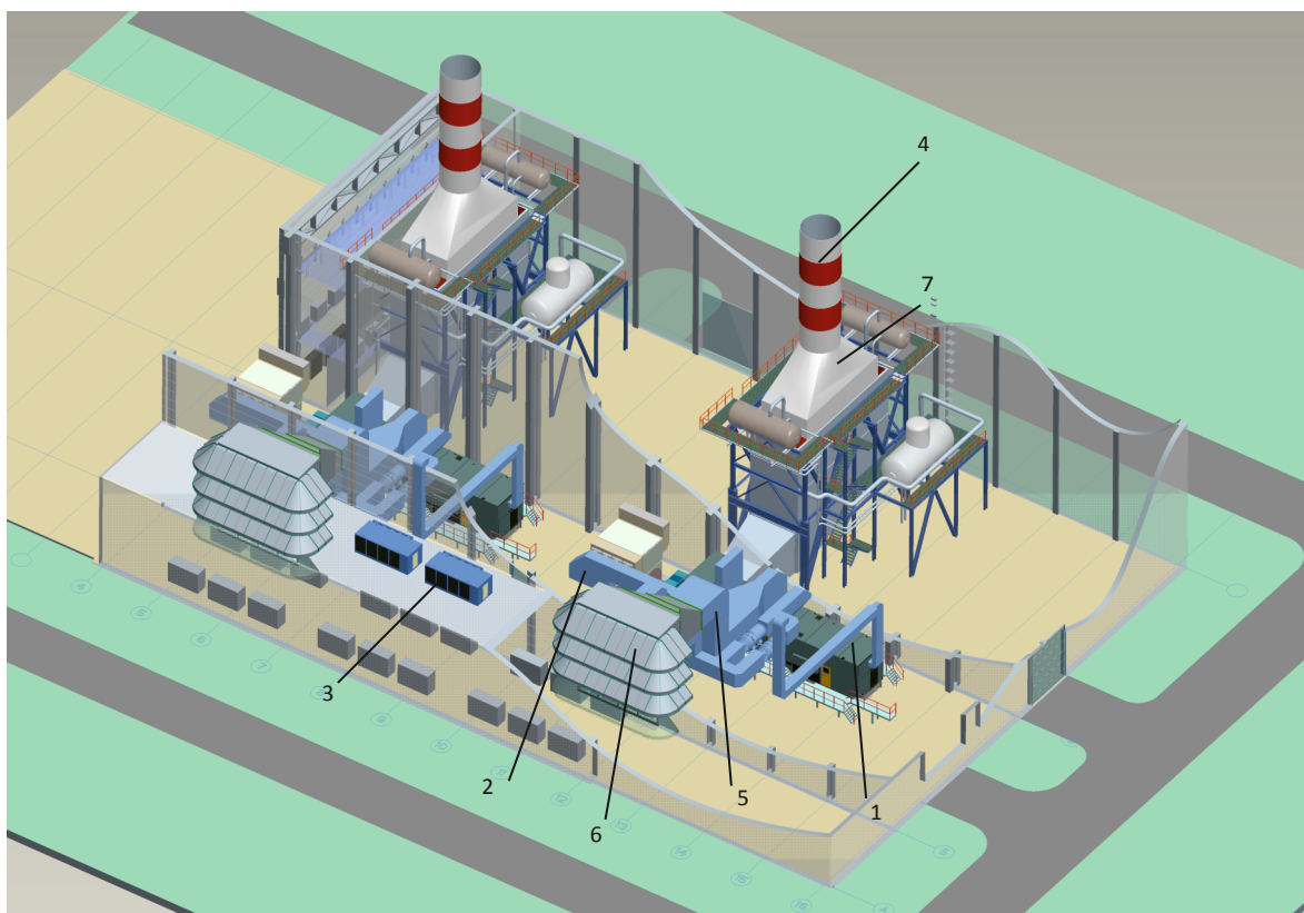
Компоновка основного оборудования ГТУ-ТЭС (мощностью 64 МВт)
