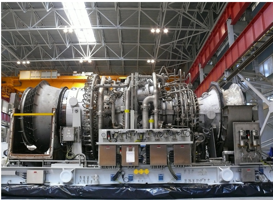
ГТУ MS5002E производства «РЭП Холдинга»
