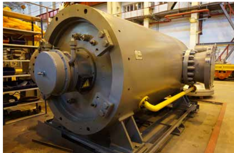
Centrifugal Compressor 285-61-1СМП
