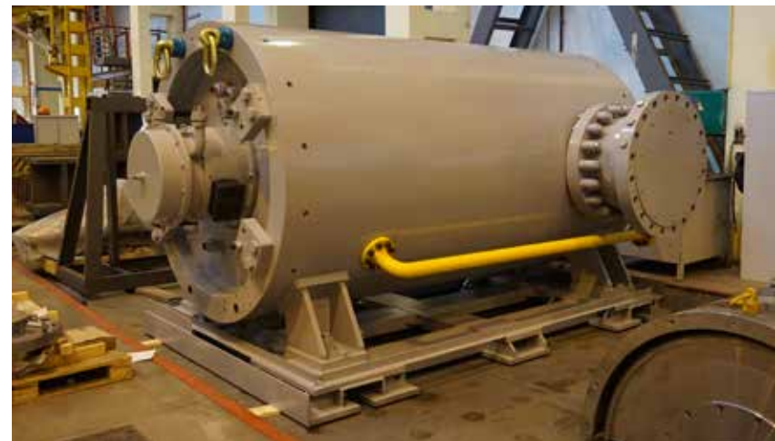
Centrifugal Compressor 910-41-1СМП
